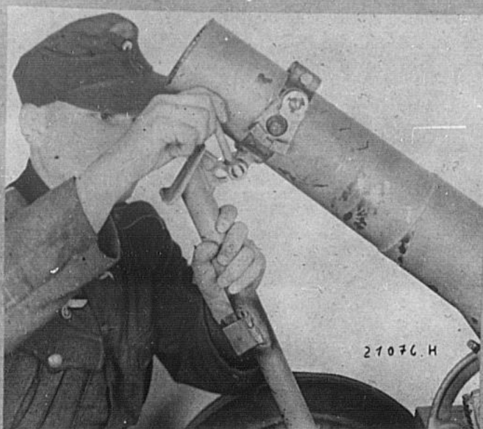
Einlegen der Stütze am Rohr
